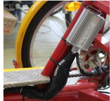
Steuergerät befestigen (Öffnung unten)
