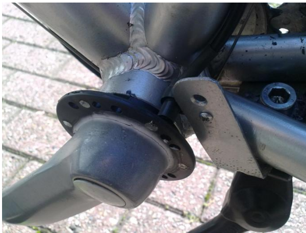
Befestigungsmöglichkeit des Sensors
