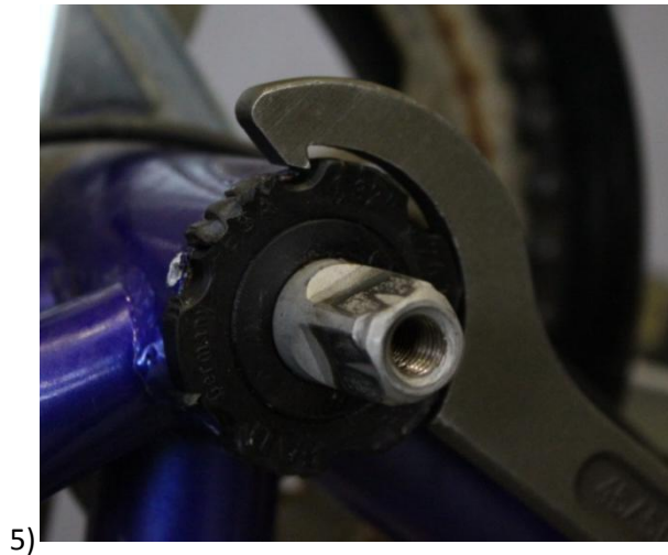
Gelenkhakenschlüssel zum Lösen des Tretlagers
