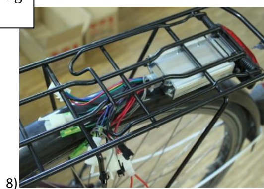
Befestigungsmöglichkeit für den Controller
